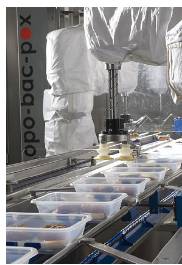
Auflegen von Käsescheiben durch Scara-Roboter / placing chees slices by scara robot
