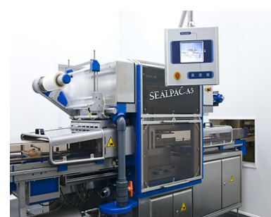
Versiegelung der Schalen auf einem Tray-Sealer / sealing the filled trays on a tray sealing machine
