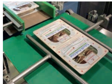
Transport der Verpackung auf Hygiene- band / transport of the package on hygienic conveyors
