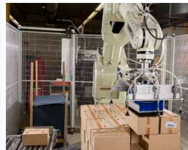
Roboter-Palettieren mit Flächensaugern / robot palletizing with flat suction cups
