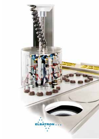
Scara-Roboter mit 12-fach Greifer für Pralinen / scara robot with 12-up gripper for chocolates
