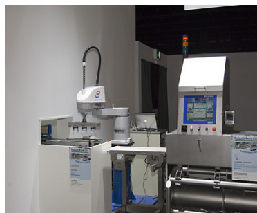
Produktinspektion durch Röntgenanlage und Gewichtskontrolle / product inspection by x-ray and check weighing
