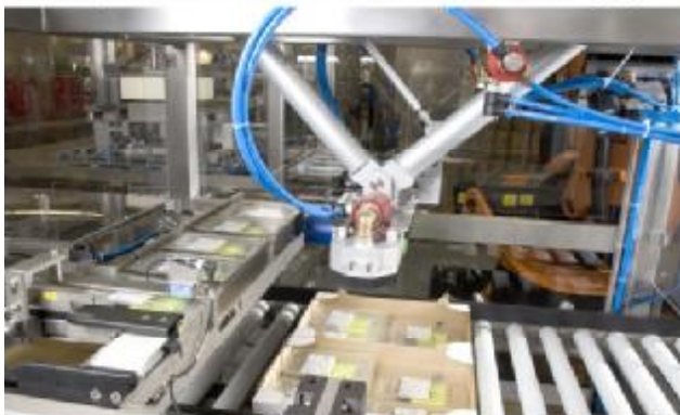
Verpacken von Produkten mittels eines Wächter "Top Loadings System"
