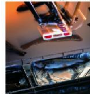
Verpacken von Frischfisch mittels eines Pickers der imt-robot Ag
