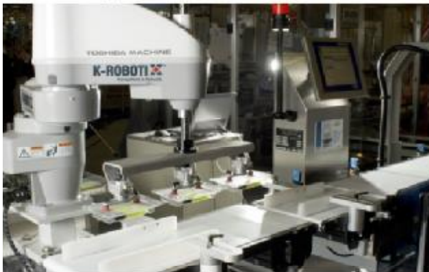
Produkt-Inspektion mittels eines GARVENS-METTLER-TOLEDO Wägesystems
